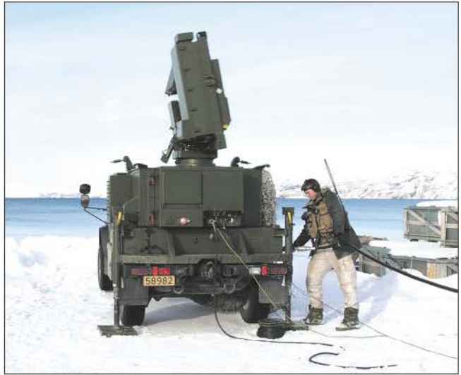
Пусковая установка (вверху) и РЛС зенитного ракетного комплекса НАСАМС II
