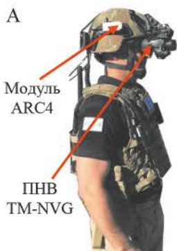
Размещение ПНВ TM-NVG и модуля ARC4 на экипировке военнослужащего (А); пример отображения картинки с ПНВ с наложенными элементами дополненной реальности (Б)
