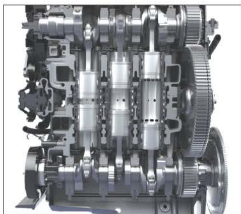
Схема оппозитного двигателя вертикальной установки компании «Ачатес пауэр»
