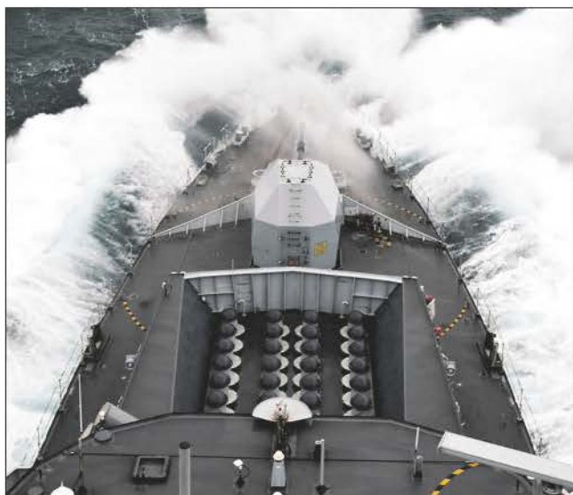
Носовая установка вертикального пуска ЗРК «Си Септор» фрегата типа «Дюк»
