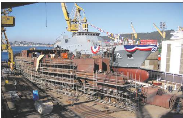
Строительство патрульного корабля проекта OPV-80 на судовой верфи корпорации АСМАР в г. Талькауано
