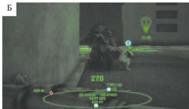
Размещение ПНВ TM-NVG и модуля ARC4 на экипировке военнослужащего (А); пример отображения картинки с ПНВ с наложенными элементами дополненной реальности (Б)
